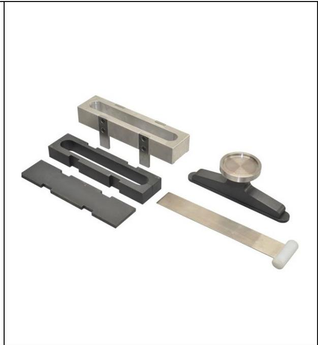
Figura 4 – Caixa de macho de flexão
